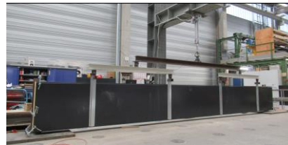
Bild 2: Exemplarischer Versuchsaufbau eines exzentrisch belasteten Sandwichelements
