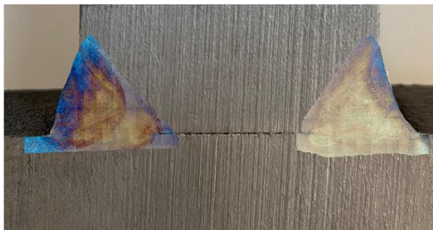
Bild: Mikroschliffaufnahmen einer DHY-Schweißnaht
