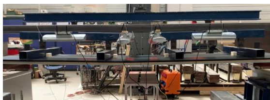
Versuch eines Sandwichbauteils unter erhöhter Temperatur
