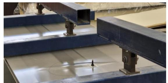
Biegeversuch eines Sandwichelements mit Blase
