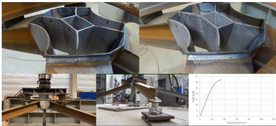
Versuch zur Tragfähigkeitsbestimmung eines WAAM-Knotens
