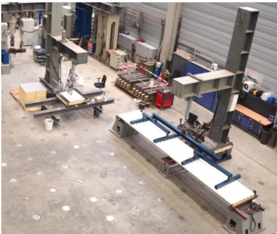
Mit hydraulischen Prüfmaschinen können Lasten bis zu 5.000 kN aufgebracht werden. Unter anderem werden bei uns folgende Themen experimentell untersucht:
