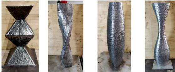
(WAAM-gefertigte Stützelemente mit unterschiedlichen Querschnitten)
