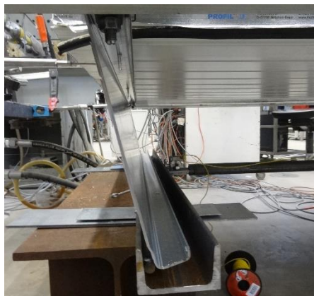
Bild 2: Verdrehte Pfette im Versuch
