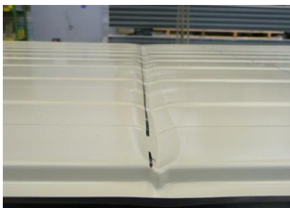
Bild: Knitterversagen (links), effektive Querschnittsfläche (rechts, nach [Nelke])
